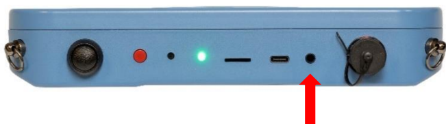
Figure 2.10 : Prise audio de l'unité de mesure du RD510
