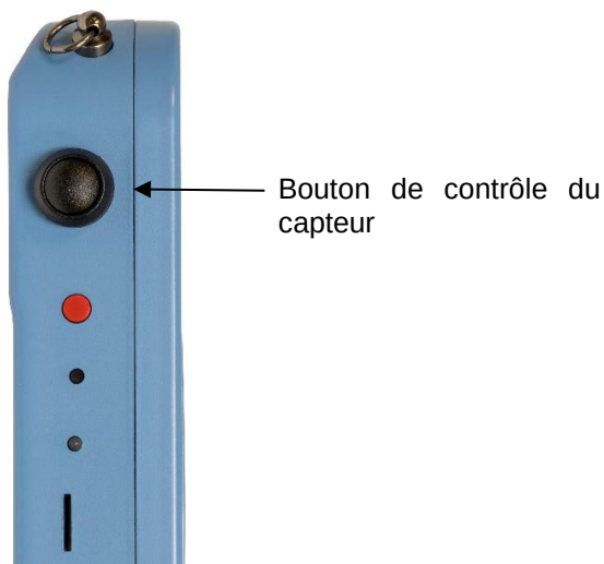
Figure 4.10 Activation du capteur acoustique du RD510
