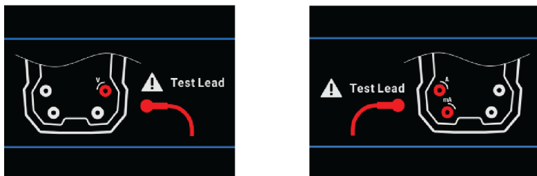
Fig. 9.1 Écrans d'erreur de connexion du cordon de test
