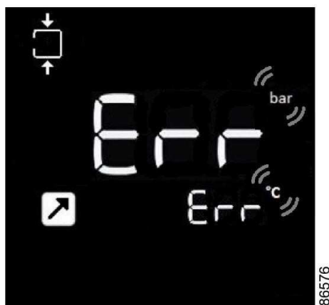
Erreur des capteurs de pression et de température
