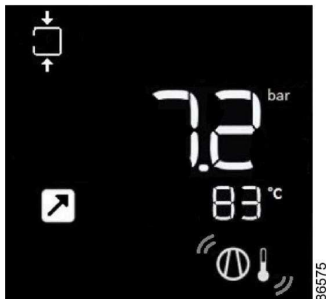
Écran principal avec arrêt par interrupteur de température
