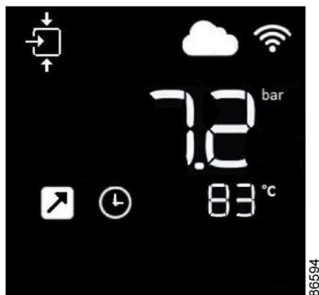
Écran principal avec programmation de la minuterie active
