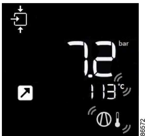
Écran principal avec avertissement de température de sortie
