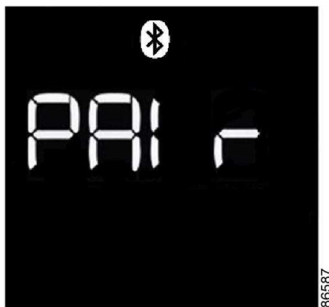
Écran appairage Bluetooth/mode discovery
