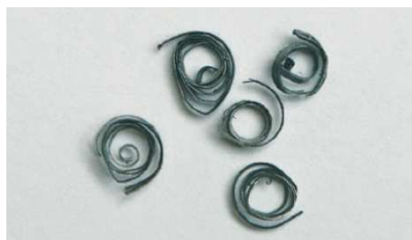
De gros copeaux à enroulement très serré ou présentant des nuances bleutées signalent une avance trop élevée
