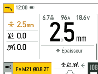
IHM - dévidoir actif
