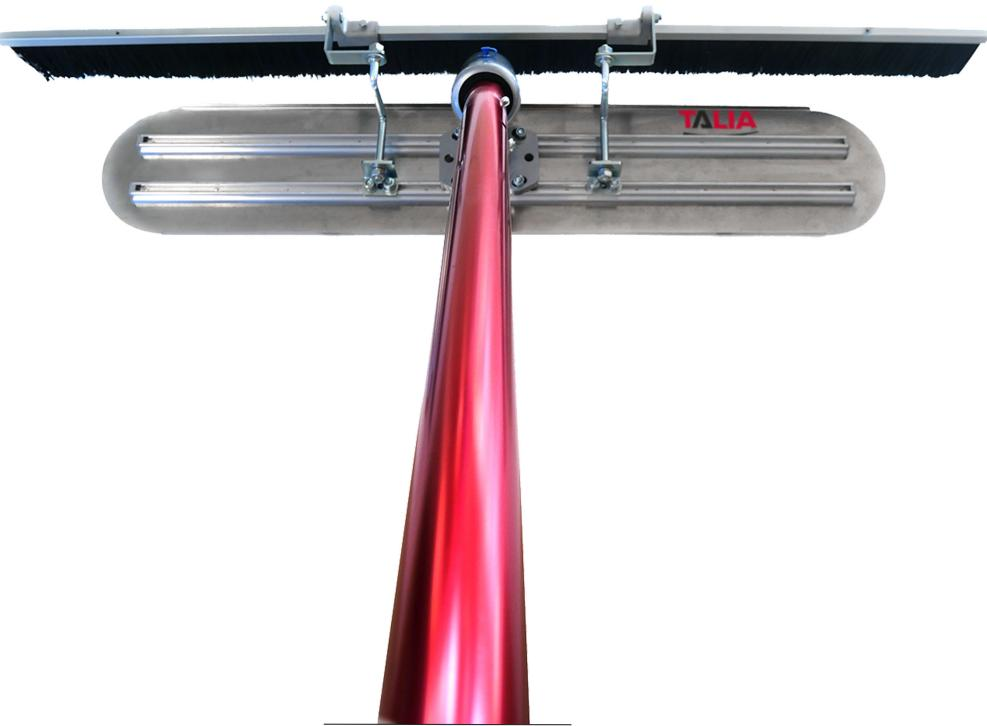
**1/ Placez les 4 boulons fournis dans le rail de la lissarde.
