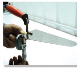
contrôle épaisseur lame
