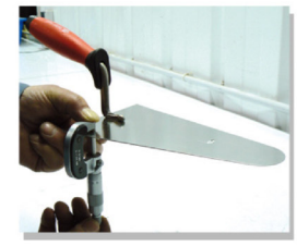
contrôle epaisseur lame
