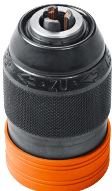
Mandrin de perçage en métal de la marque Röhm avec mors de serrage en acier trempé et forces de serrage élevées. L'embout de vissage peut rester dans l'arbre d'entraînement, le mandrin de perçage se glisse sur l'embout. Couple maximal 120 Nm. Compatible avec toutes les visseuses sans fil FEIN avec interface QuickIN/QuickIN MAX.
