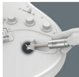
L'outil pour prise jack contenu dans le set permet de bien positionner la prise jack lors du montage et du démontage. L'écrou hexagonal extérieur est serré ou desserré à l'aide de la douille Zyklop.
