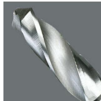
Mèche hélicoïdale - pour applications métal • emmanchement  $\frac{1}{4}^{\prime\prime}$  convenant pour porte-embouts répondant à la norme DIN 3126-D 6,3 (ISO 1173) • très bonne transmission de puissance grâce à la queue hexagonale • acier rapide haut rendement HSS, avec affûtage en croix • élasticité adaptée du matériau, pour une longévité accrue • très bonne précision de concentricité • embouts à finition extra-rigide pour une durée de vie particulièrement longue
