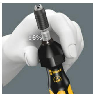
Précision de mesure  $\pm 6\%$  (article 1430 :  $\pm 10\%$ ) conformément à la norme DIN EN ISO 6789. Déclic parfaitement audible/tangible lorsque la valeur de couple paramétrée est atteinte.
