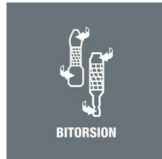
Les pics de contraintes survenant lors du vissage mécanique entraînent souvent une usure précoce de l'embout ou la destruction de la vis. Minimiser ces pics de contrainte permet d'accroître la productivité et la sécurité du vissage. Le système BiTorsion Wera prévient l'usure précoce. La durée de vie de l'outil est rallongée et la productivité accrue de façon significative lors du vissage mécanique.
