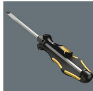
Le tournevis-burin est la solution si vous ne voulez pas vous contenter de visser. - Pour visser, buriner, mater et libérer des vis ou des colliers de serrage récalcitrants. Avec capuchon de frappe intégré, pour une longévité accrue et une diminution du risque d'éclatement. Avec lame hexagonale traversante réalisée.
