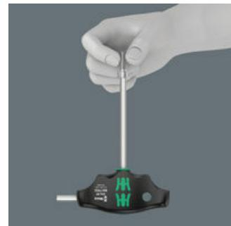
Le serrage de la vis à six pans creux sur la pointe de l'outil est assuré par une bille élastique. C'est particulièrement utile dans les endroits exiguës où il n'est pas possible de tenir la vis avec l'autre main.
