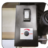
Moteur et boutons de commande indépendants pour le tapis de convoyage
