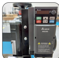
Onduleur DELTA permettant de régler la vitesse de rotation du cylindre
