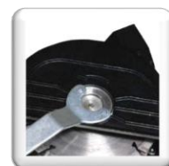
Taquet d'arrêt facilitant le changement des disques et le réglage des rondelles d'écartement
