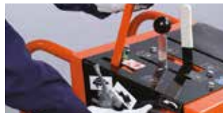
COMMANDE MANUELLE OU HYDRAULIQUE DE MONTÉE ET DESCENTE DU DISQUE
