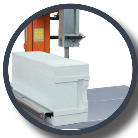
Arrêt automatique du ruban en fin de coupe
