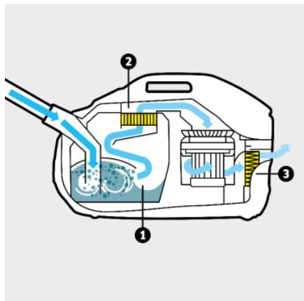
**Système de filtration à plusieurs niveaux, incluant l'innovant filtre à eau, un filtre intermédiaire lavable et un filtre HEPA 13 (EN1822:1998)**
